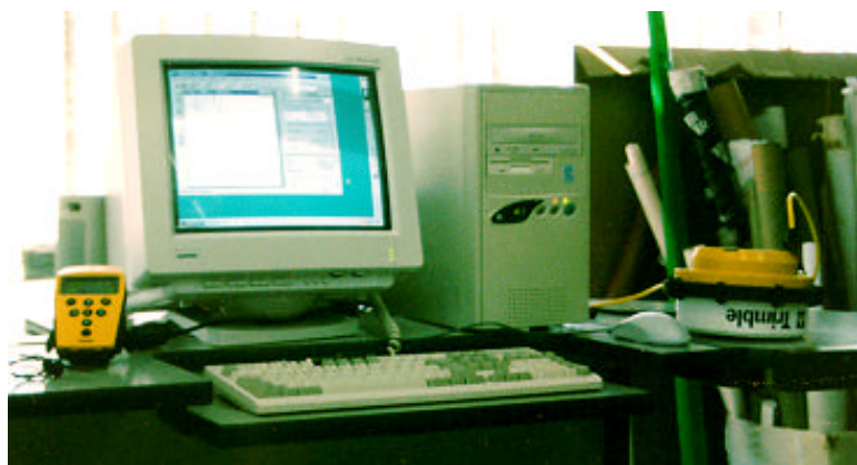
Foto 05. Fase de pós-processamento. Descarregando os dados do Geoplotter (à esquerda) no software Pathfinder Officer 2.02. à direita, GPS geodésico 4600 LS
