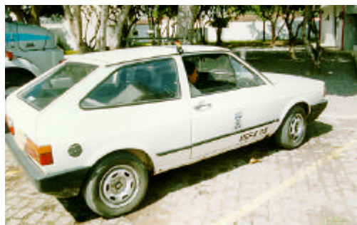
Foto 01. Veículo utilizado, com antena externa acoplada ao Geoplotter II (Trimble)
