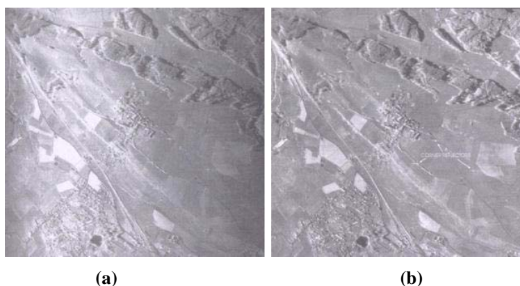
Figura 1. Imagem SAR de Weiheim, Alemanha (AeS-1, banda X): antes (a) e depois da correção radiométrica (b).
