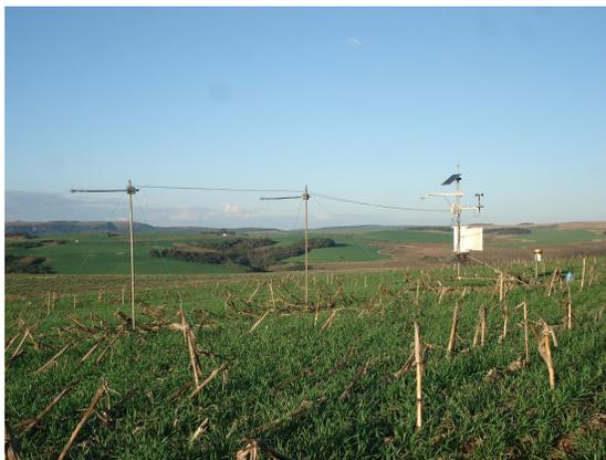
Figura 1 - Plataforma de coleta de dados, composta por sensores de saldo de radiação. Fazenda Cambará, Pirai do Sul – PR.
