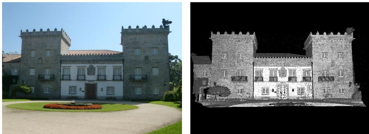
Figura 1. Paço de Quiñones de León e a nuvem de pontos adquirida pelo Laser Scanner Terrestre
