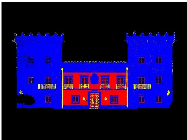
Figura 3. Fachada classificada (granito em azul, parede branca em vermelho e ferro em amarelo)
