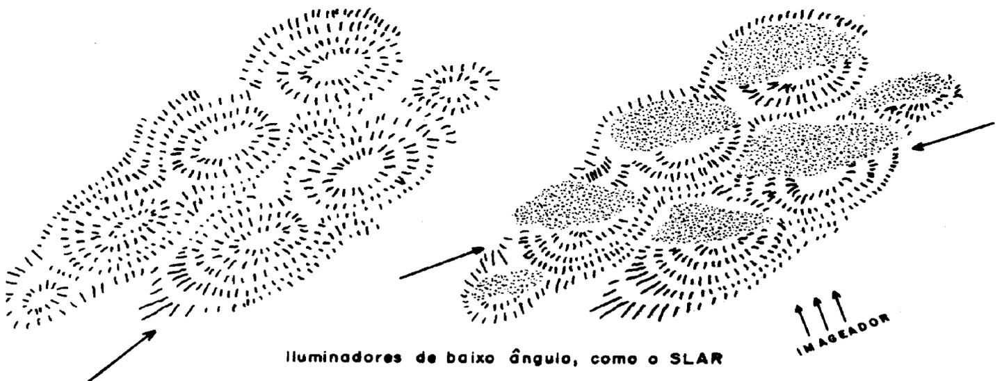
Fig. 3 - Defeitos e ilusões óticas na interpretação da geometria do relevo ou na organização dos detalhes fisiográficos. O primeiro é uma ilusão ótica por fixação mental de padrões preconcebidos da simetria básica (círculos e retas) e o segundo é, um defeito introduzido na imagem pelo excesso de retorno especular em imagens de
