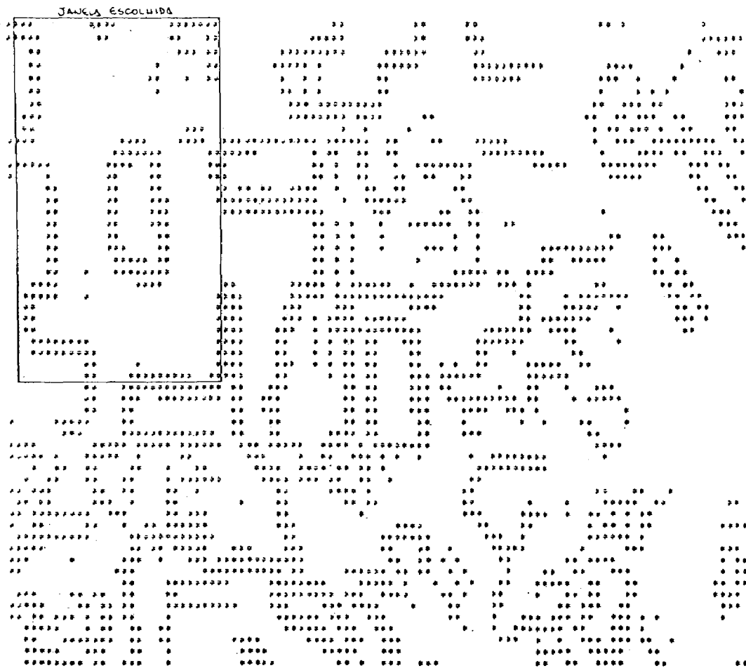
Fig. 2 - Exemplo de busca automática de pontos de apoio: parte de imagem LANDSAT indicando a janela escolhida (atributos significativos).
