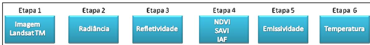
Figura 3 – Fluxograma das etapas do processo de obtenção da temperatura de superfície.
