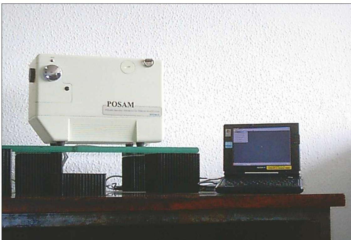
Figura 1. Espectrorradiômetro POSAM (Portable Spectrometer for Analytical Mineral Identification) do Laboratório de Sensoriamento Remoto e Espectrorradiometria da CPRM
