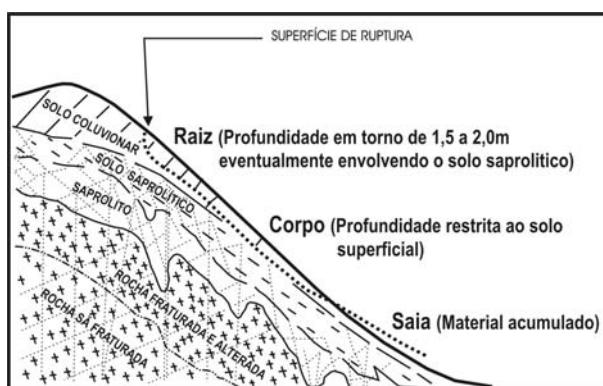
FIGURA 3 – Seção típica do escorregamento translacional raso (planar).
