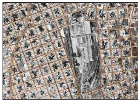
Figura 6 - Aerofoto ortorretificada com sobreposição da planta cadastral.
