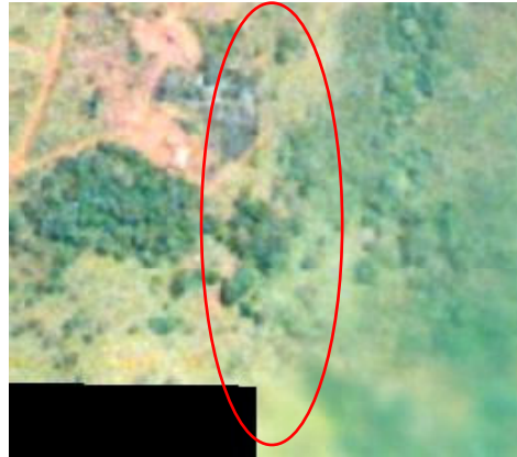
Figura 1. Problema de mosaico de imagens: necessidade de aplicação de técnicas de blending na área de sobreposição (destacada pela elipse em vermelho).
