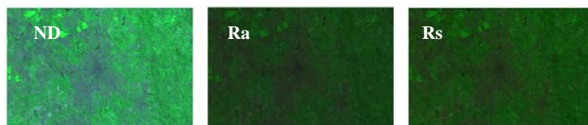
Figura 4: Imagem CCD original (ND) e imagens transformadas para reflectância aparente (Ra) e reflectância de superfície (Rs). Composição colorida R3G4B2 sem contraste.
