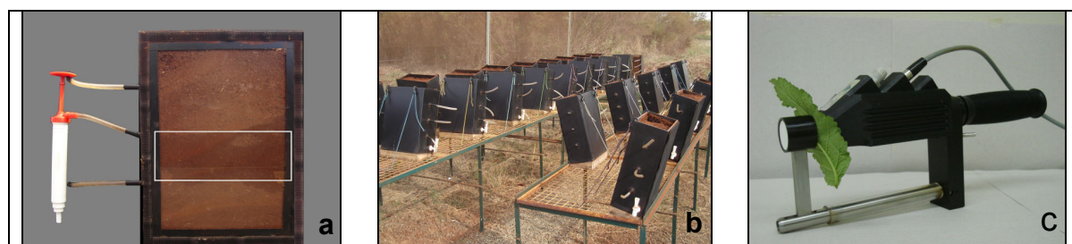
Figura I – (a) bomba injetora, lisímetro e área de vazão em destaque; (b) instalação; (c) leaf clip
