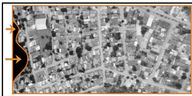
Figura 3 – Correção na imagem HSS da distorção provocada pela rolagem da aeronave.
