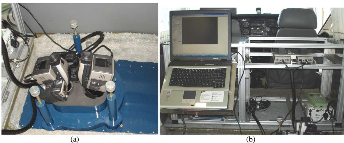
**Figura 1:** Sistema Aerotransportado de Aquisição de Imagens digitais: (a) plataforma de coleta; (b) unidade de controle e alimentação.
