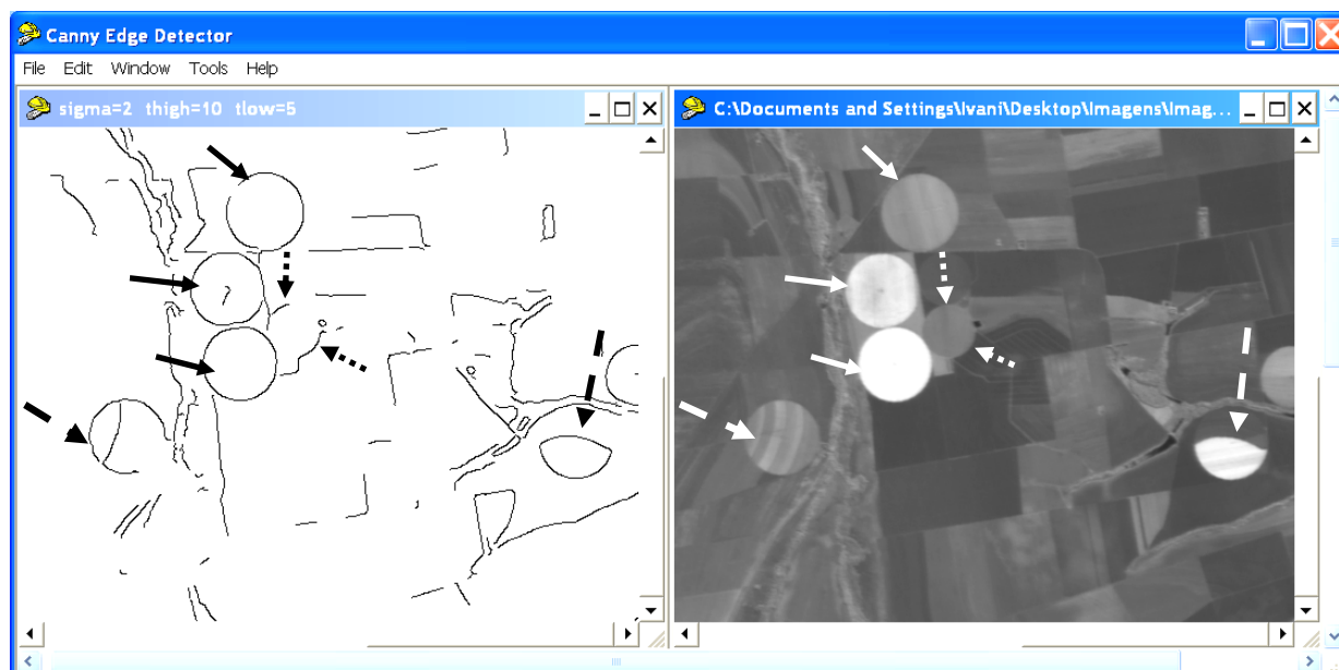
Figura 3. Detecção de bordas de uma imagem CBERS CCD (banda 4) a partir do software “ Canny Edge Detector ” de N. Papamarkos.
