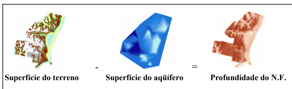
Figura 3: representação gráfica do cálculo da profundidade do nível freático
