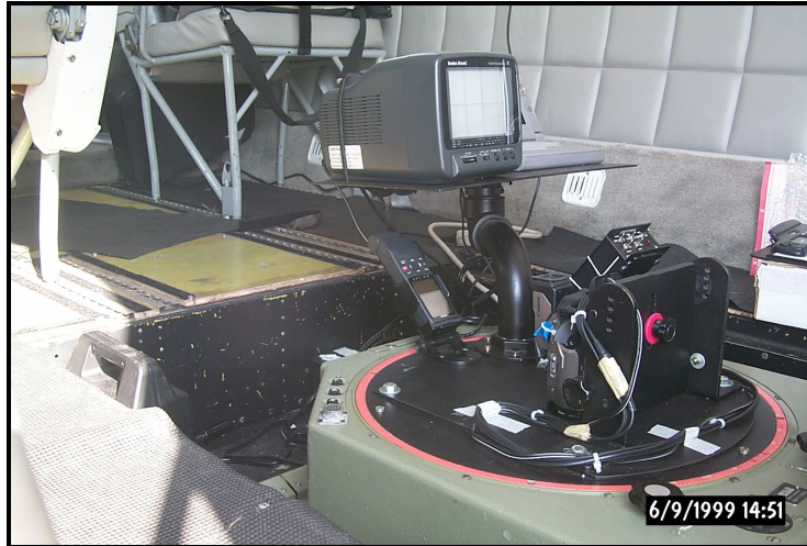
Figura 1: Câmera de Videografia e GPS instalados na aeronave Fonte: Arquivo de fotos da GEOPIX (Steffen,C.,1999)
