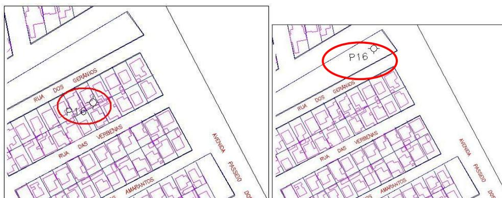
**Figura 1** - Poço (P-16) deslocado para dentro da quadra, entre fundos de lotes (fig. à esquerda) e o mesmo poço locado na posição correta (fig. à direita).
