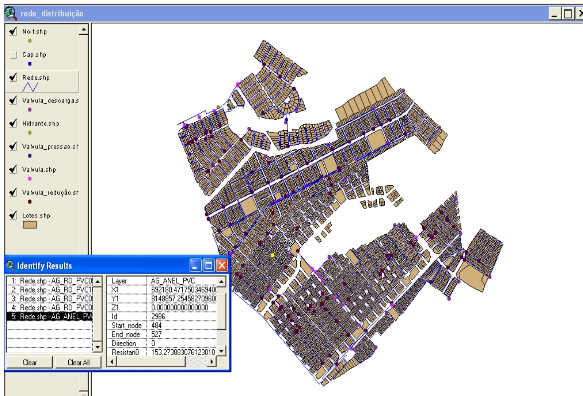
Figura 5. Sistema de informações geográficas da rede de distribuição de água da área piloto.
