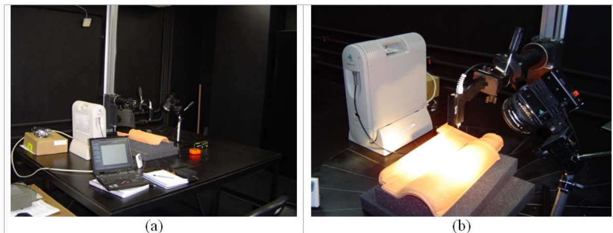
Figura 1: (a) Visão geral do Arranjo experimental utilizado nas medições Espectrais no LaRac; (b) Visão mais detalhada do mesmo arranjo realizando a medição de uma telha de cerâmica de argila vermelha;
