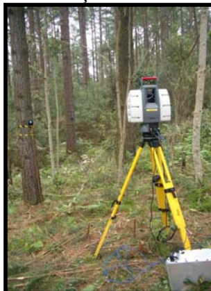
Figura 1: Coleta dos dados com o equipamento laser HDS3000 no povoamento de pinus.
