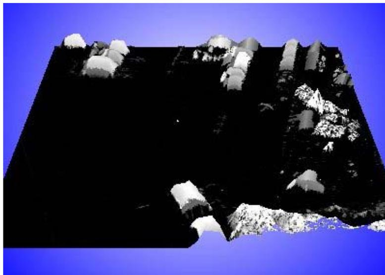
FIGURA 1 – Modelo digital de superfície normalizado MDSn.
