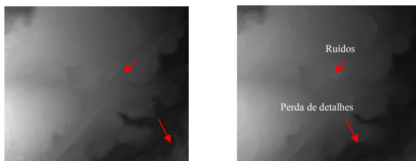
Figura 7 – MDT da área urbana gerado pelo Terra Scan e MDT do Filtro Morfológico com elemento estruturante 15x15.
