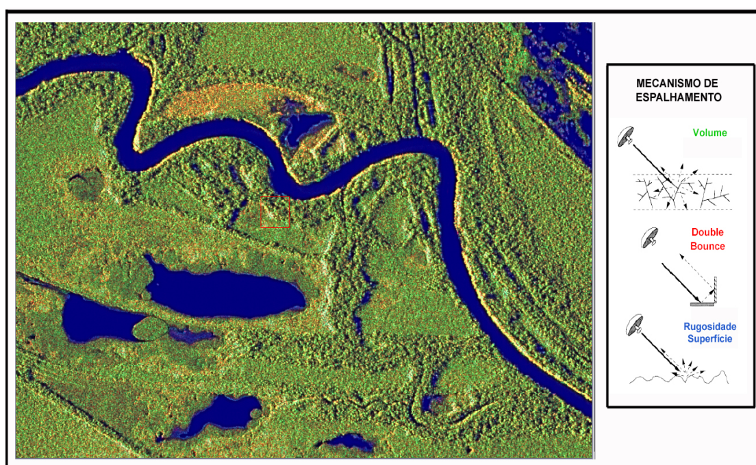
Figura 3. Composição RhhGvvBhv - Área da RDS Mamirauá: A área da RDS Mamirauá é dominada pela floresta alagada – Floresta de Várzea. Verifica-se pouca ocorrência da reflexão de canto na área devido a existência de macrófitas e gramíneas aquáticas, possuindo estas uma estrutura de porte baixo. Verifica-se a existência de várias planícies aluviais vegetadas com espécies de porte médio contribuindo para o espalhamento volumétrico. A reflexão especular é dominada pela superfície dos lagos e “paraná” encontrados no local.
