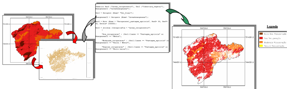
Figura 3. Representação da integração dos produtos cartográficos temáticos: Mapa das Zonas Homogêneas à Capacidade de Infiltração / Mapa de áreas de Pastagem e Atividade de cultura Agrícola. Destaque para linha de comando elaborada em LEGAL (Câmara, 1996).
