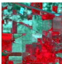
Figura 2. Imagem hiperespectral obtida pelo sensor AVIRS. Apresenta-se uma composição colorida RGB utilizando as bandas correspondentes aos comprimentos de onda 860, 657 e 557 nm.
