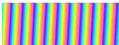
Fig. 4.2: interferograma sintético da fase devida à forma elipsóidica da Terra.
