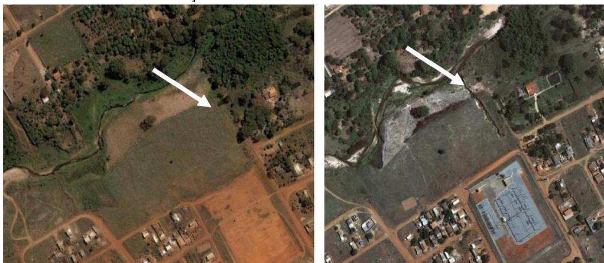
Figuras 08 e 09 – Caracterização do processo de erosão - Imagem do Satélite QuickBird – 2002/Imagem do Satélite GeoEye – 2008 (Fonte: Digital Globe).
