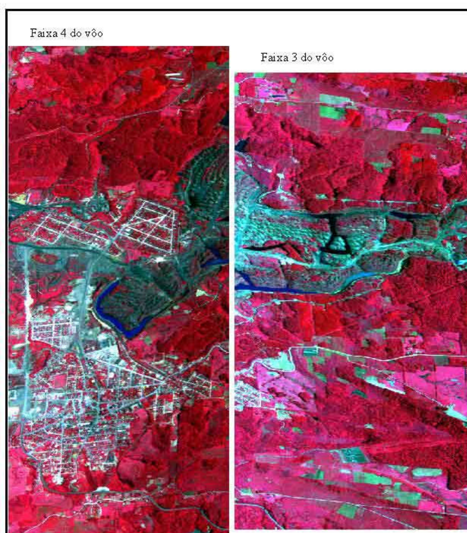
Figura 1- Composição colorida na bandas 4(R), 7(G) e 2(B) das faixas de voo 3 e 4 do CASI
