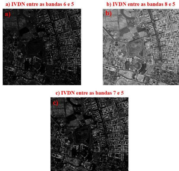
Figura 3. Imagens IVDN obtidas a partir das bandas espectrais “vermelho”, “borda do vermelho”, “IR1” e “IR2” do satélite WorldView 2.
