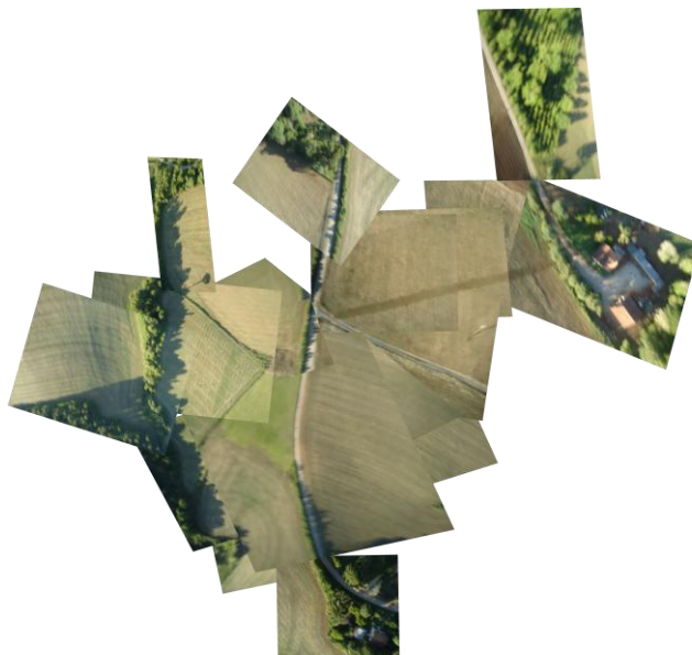
Figura 05. Mosaico não-controlado obtido pelo voo aerocontrolado em uma área restrita
