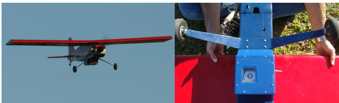
Figura 03. Cápsula blindada para acomodação da câmera adaptada à aeronave
