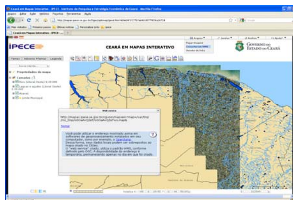
Fig. 12 – Exemplo de conexão WMS realizada, gerando-se uma URL para acesso das informações via SIG's Desktop.
