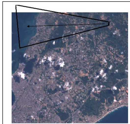
Figura 6 – Direção de propagação do fluxo do particulado proveniente da britagem, de acordo com observação da precipitação na vegetação próxima.
