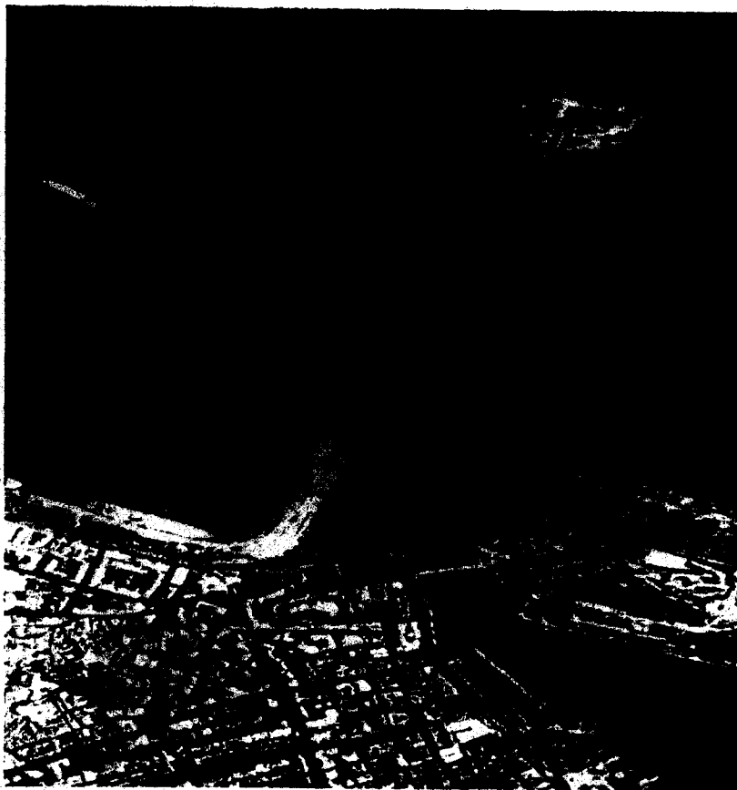
Fig 4. Banda 6 do Sensor CASI, com intervalo de 645.5 nm a 645.7 nm, dados brutos da Baía de Guanabara.
