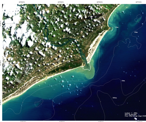
Fig. 1. Sub-cena imagem TM LANDSAT, órbita ponto 214/67 da Foz do Rio São Francisco. Data: 05 de setembro de 2001. Horário: 12:18:09 GMT. Composição colorida RGB (TM 3,2,1). Linhas sobre a água representam as isobatimétricas de 10, 20, 50 e 200 m.
