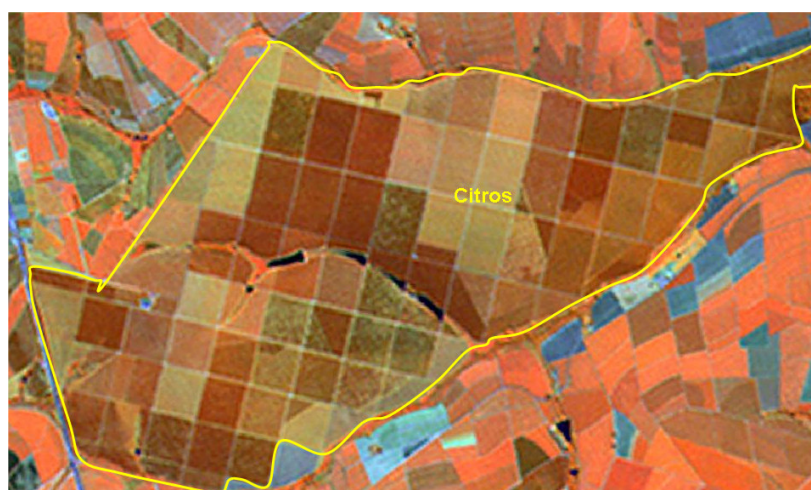
Figura 3 – Imagem do sensor TM/Landsat-5, em composição colorida TM4(R), TM5(G) e TM3(B), para mostrar as variações na tonalidade de áreas de citros (dentro do polígono amarelo).
