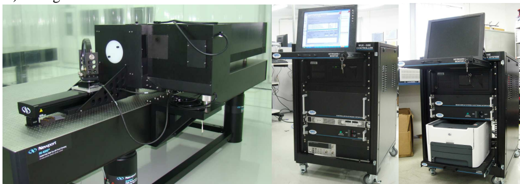
Figura 1 - Colimador principal sobre mesa óptica, rack do controlador GSE – MUX e rack do IDS do GSE – MUX, respectivamente. FONTE: Opto Eletrônica S.A.
