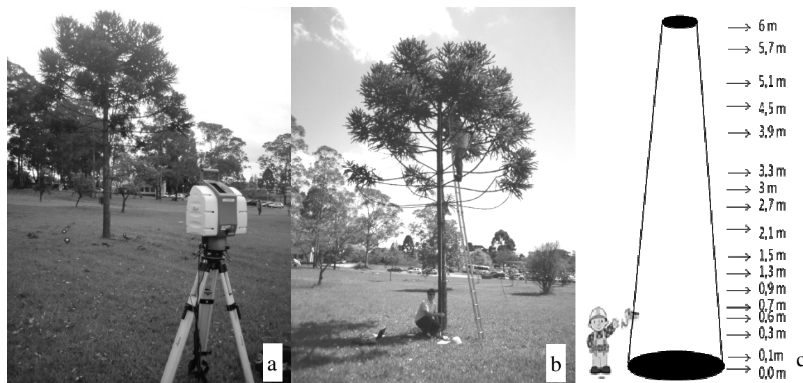
Figura 1: a) equipamento laser em operação; b) medições diretas em campo; c) altura das medições das circunferências.
