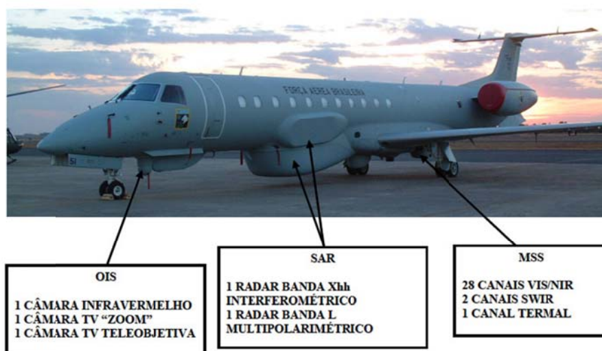
Figura 2 - Sensores imageadores embarcados na aeronave R-99
