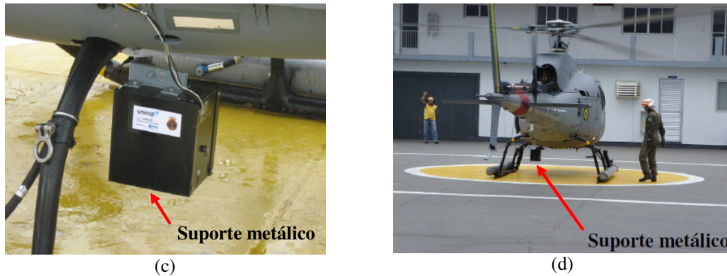
Figura 2. Suporte metálico e câmera digital Sony acondicionada no suporte (a,b), instalação do equipamento na barriga da aeronave (c) e posição do suporte metálico no helicóptero (d).
