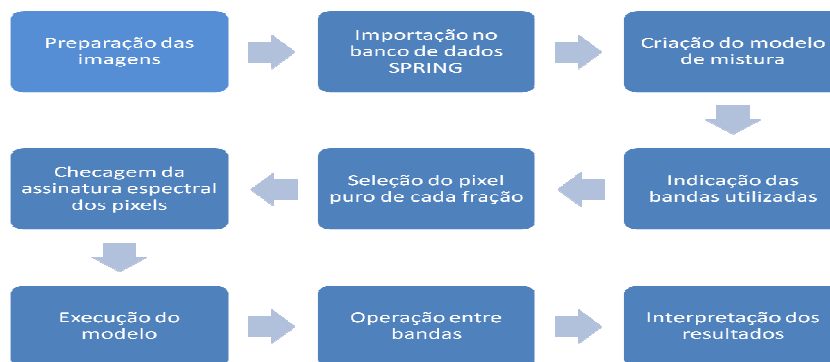
Fig.4 – Fluxograma do modelo linear de mistura espectral no SPRING.
