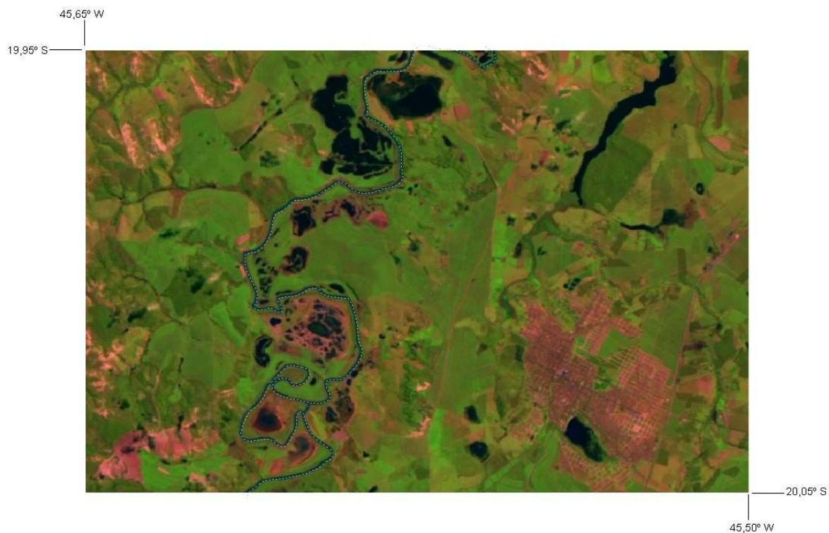
Figura 2. Sobreposição do curso vetorizado do rio São Francisco sobre imagem ortorretificada do satélite Landsat 5 do Projeto EarthExplorer.
