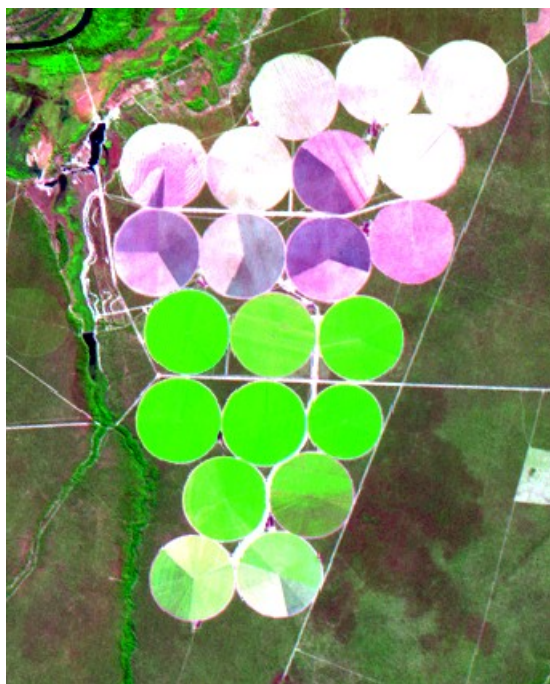
Figura 3. Pivôs centrais visualizados sob diferentes estádios de vegetação em imagem IRS, órbita-ponto 331-089, composição 543/RGB.
