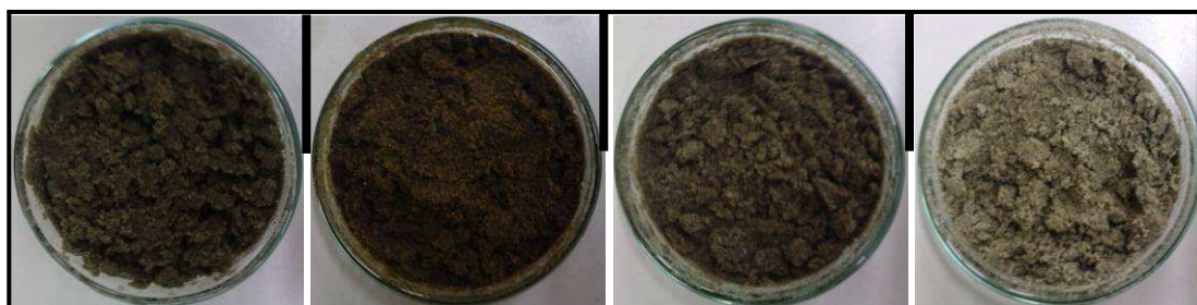
Figura 1: misturas de areia contaminadas com A-água, B-óleo O2, C-diesel e D-gasolina O3. Escala: 3,0 cm.
