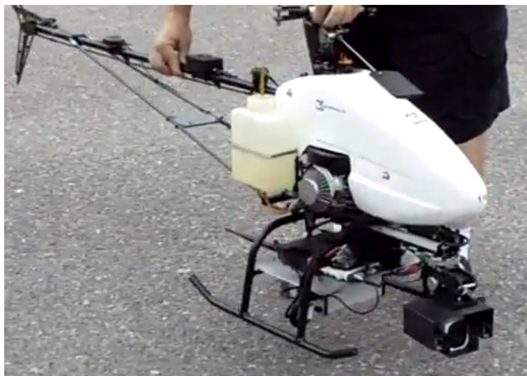
Figura 3: VANT SR30 desenvolvido com motor a gasolina
