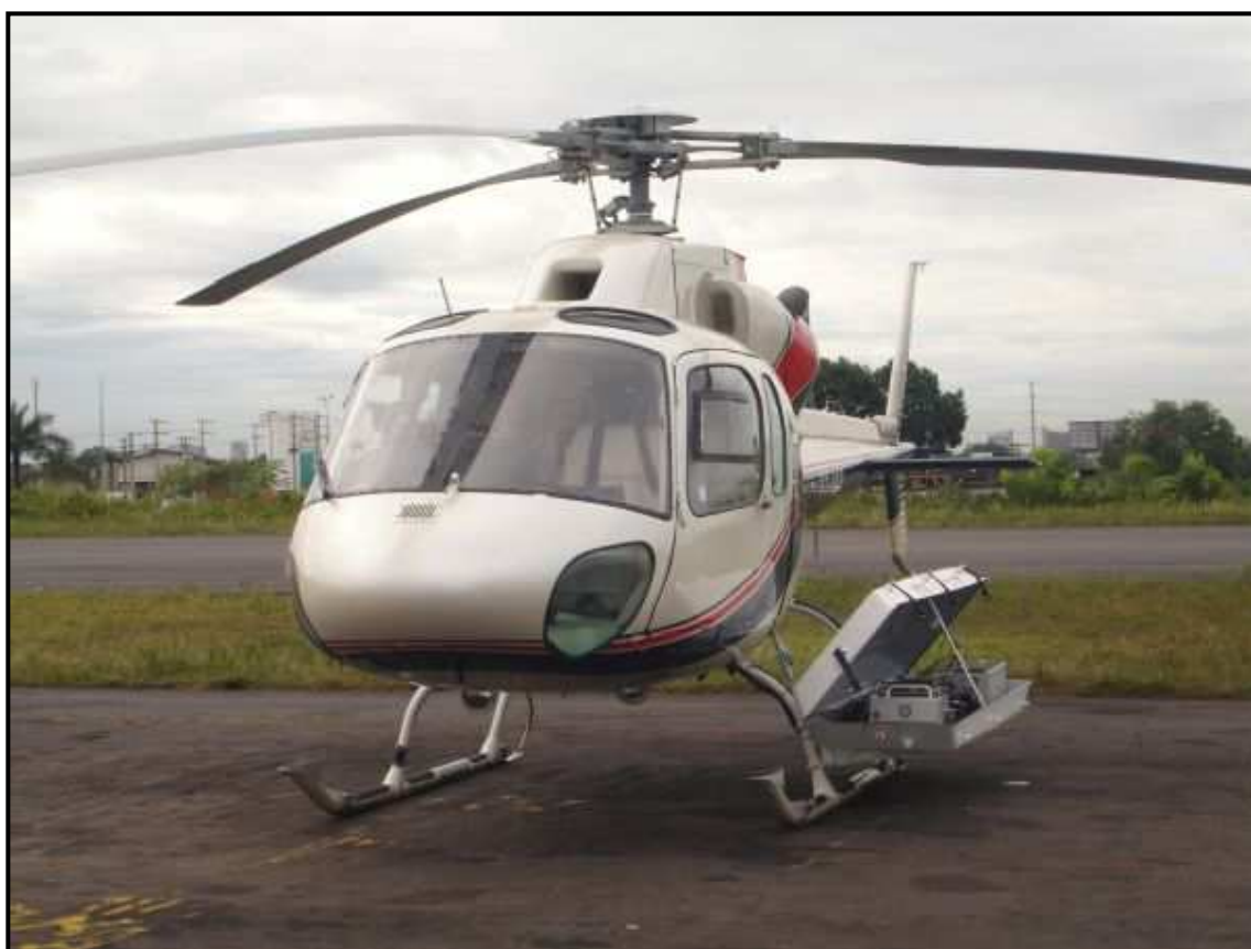
Figura 01: Equipamento completo montado no “ski” do helicóptero modelo Bell
