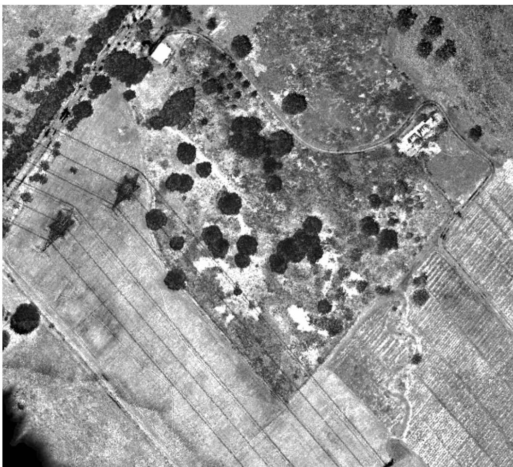
Figura 07: Imagem originada somente pelos valores de intensidade dos pulsos laser.
