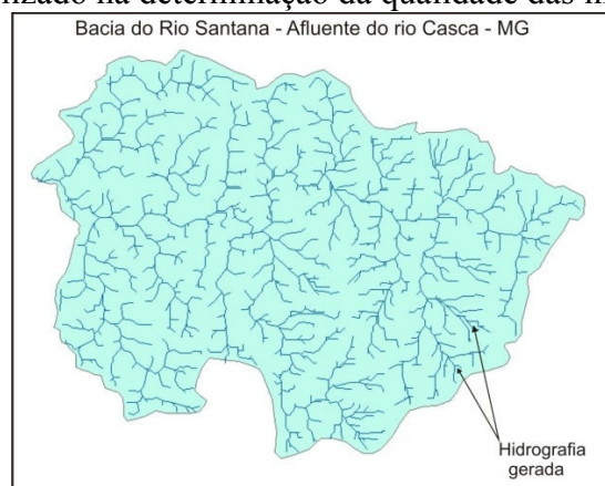
Figura 6- Hidrografia gerada utilizando MDE SRTM com correção das falhas.
