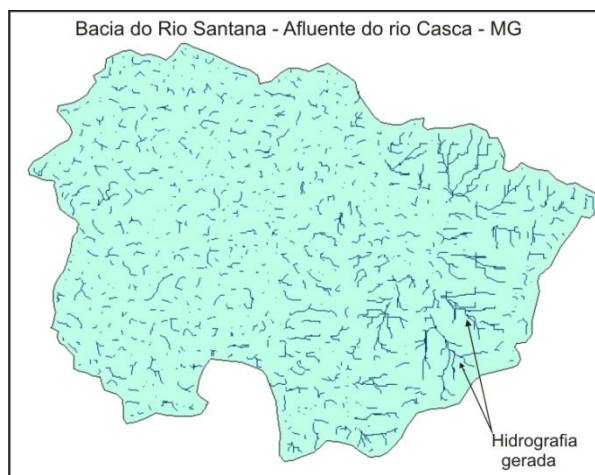
Figura 4 – Hidrografia gerada utilizando MDE ASTER sem correção das falhas
