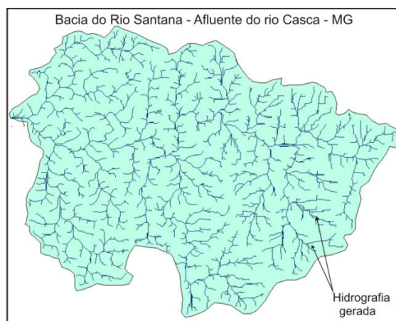
Figura 5 - Hidrografia gerada utilizando MDE ASTER com correção das falhas.
