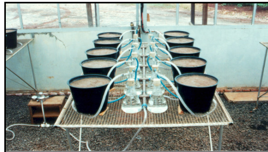
Figura 2: Sistema de injeção de gás. No chão, à esquerda, uma das válvulas de alívio de pressão e o mecanismo de distribuição de GNV para as duas mesas.
