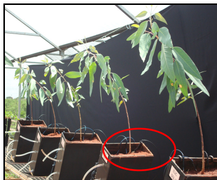
Figura 4: Sistema de irrigação espaguete, instalado com três canálculos por lisímetro. Vazão diária total de 300 mL para cada um.
