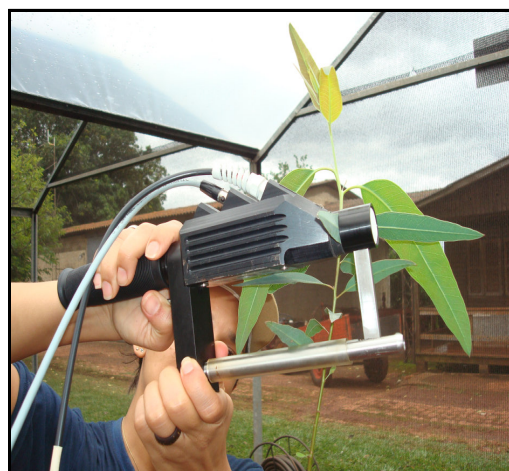
Figura 6: Acessório Leaf Clip utilizado para obtenção das medidas radiométricas das folhas do EC in situ – EHL.
