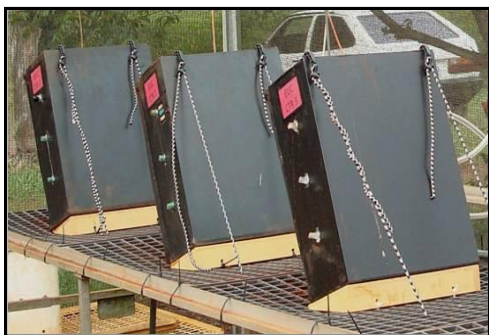
Figura 3: Disposição dos lisímetros do tratamento CTR, com inclinação de 15° e presos às grades com o auxílio de elásticos de bagageiro de moto.
