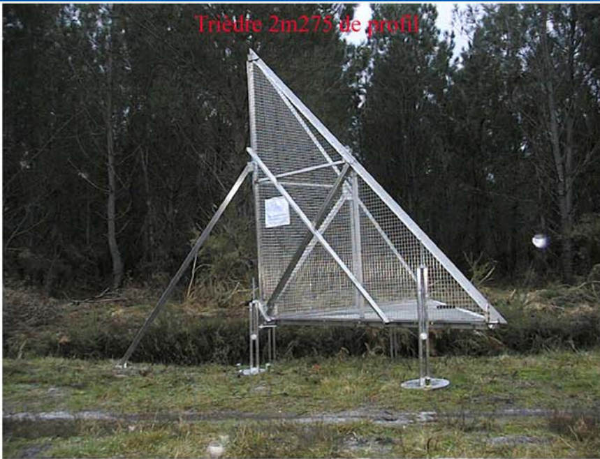
Dièdre de profil avec angle de dépolariation de 22,5^\circ
